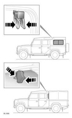
Comprimez le mécanisme de verrouillage et faites coulisser la vitre dans la position désirée. Relâchez le verrou et veillez à ce que le loquet soit bien enfoncé dans une douille de verrouillage.
