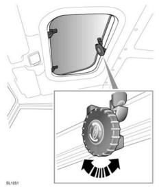
Tournez la molette dans le sens des aiguilles d'une montre pour ouvrir le toit ouvrant et dans le sens inverse pour le fermer.
