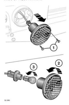
Pour déposer le bloc optique arrière :
