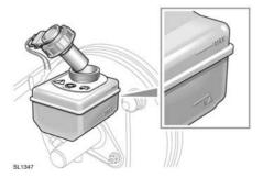
Vérifiez le niveau du liquide à travers le côté du réservoir transparent.
