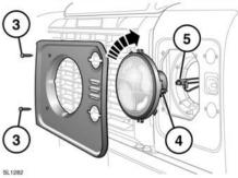
Pour changer l'ampoule d'un phare, vous devez d'abord retirer le bloc optique.
