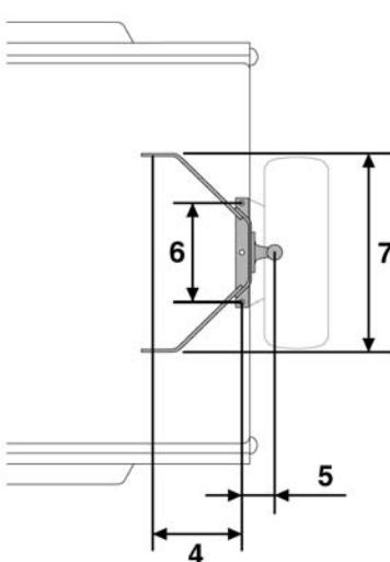
**Note :** Les dimensions, exprimées en millimètres, concernent l'équipement de remorquage commercialisé officiellement par Land Rover.
