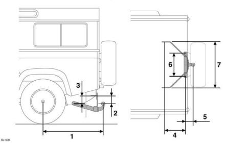
**Note :** Les dimensions, exprimées en millimètres, concernent l'équipement de remorquage commercialisé officiellement par Land Rover.
