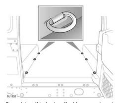
Sur certains véhicules, le coffre à bagages est muni d'anneaux de fixation de charge qui permettent de fixer les bagages en toute sécurité.
