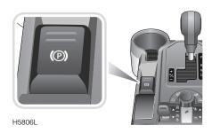
Para aplicar el freno de mano, levante la palanca y suéltela. En el cuadro de instrumentos permanece iluminada una luz de aviso ROJA.
