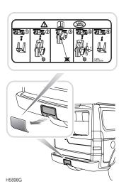
La etiqueta pegada a la superficie interior de la tapa de acceso del parachoques trasero, describe el procedimiento de montaje y desmontaje del gancho de remolque.
