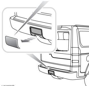
La etiqueta pegada a la superficie interior de la tapa de acceso del parachoques trasero, describe el procedimiento de montaje y desmontaje del gancho de remolque.
