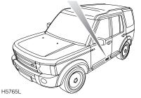
Las presiones de inflación aplicables a distintos neumáticos y estados de carga del vehículo, aparecen en una etiqueta pegada al pilar "B" del lado del conductor.
