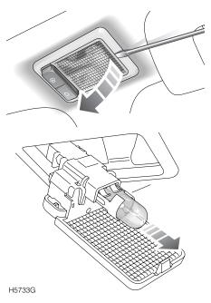
Introduzca un pequeño destornillador plano en la muesca en el costado del cristal, y apalanque el cristal con cuidado hasta sacarlo de la luz. Tire de la bombilla para desmontarla.
