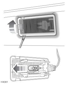
Introduzca un pequeño destornillador plano debajo del cristal y apalanque el cristal con cuidado hasta sacarlo de la luz. Tire de la bombilla para desmontarla.
