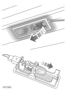
Con la puerta pertinente abierta, introduzca un pequeño destornillador de punta plana debajo del borde delantero del cristal, y haga palanca para extraer la luz de la puerta. Tire de la bombilla para desmontarla.
