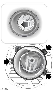
Para acceder a la bombilla; empleando una herramienta adecuada, haga palanca para extraer el cerco de la luz antiniebla del parachoques delantero. Quite los tres tornillos de sujeción para soltar la luz. Extraiga con cuidado la unidad del parachoques delantero.
