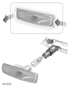
Empuje el cristal difusor firmemente hacia la parte delantera del vehículo, y desmonte la luz de la aleta. Gire para soltar el portalámpara de la luz, entonces tire de la bombilla para soltarla.
