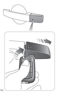
Si falla el mando a distancia, la cerradura de la puerta delantera izquierda está provista de una función de acceso de emergencia. Estando la llave metida en la ranura debajo de la tapa de la manilla, ésta puede tirarse ligeramente hacia el exterior y seguidamente desplazarse hacia atrás para desengancharlo. Ahora se puede usar la llave para desbloquear el vehículo. Para una descripción completa de esta función, vea **Bloqueo/desbloqueo de emergencia**, 44
