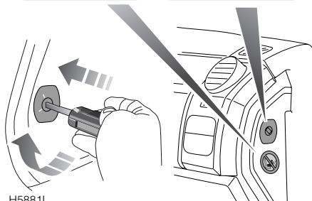
Por el lado del acompañante del coche, abra la puerta delantera e introduzca la llave de contacto en el interruptor de desactivación del airbag. Gírela a la posición de "DESCONEXION".
