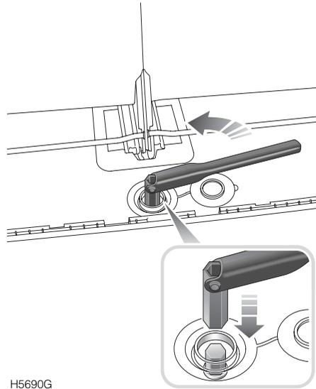
3. Conecte el berbiquí para tuercas de rueda a la tuerca del torno de elevación de la rueda de repuesto, y gírelo en sentido antihorario para bajar la rueda.
