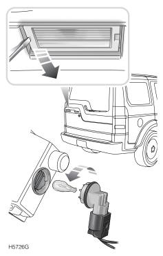
Con el portón trasero superior abierto y empleando una herramienta adecuada, desprenda el cristal de la luz del portón trasero (vea el recuadro). Gire el portalámpara en sentido antihorario para desmontarlo, y tire de la bombilla para sacarla del portalámpara.
