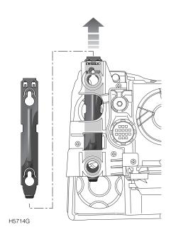
**Nota:** Para acceder a la luz intermitente de dirección, hay que desmontar completamente la corredera de bloqueo del faro.
