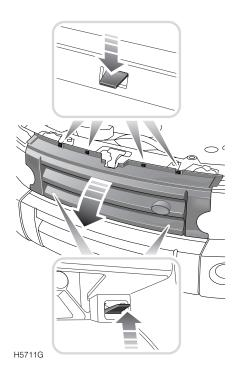
Quite la rejilla presionando hacia abajo las cuatro grapas superiores, y hacia arriba las dos superiores, que sujetan la rejilla a la carrocería del vehículo. Levante la parrilla hasta separarla del vehículo, y póngala en un lugar seguro.
