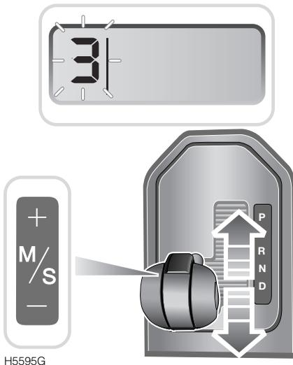
1. Le sélecteur se trouvant en position "D" (conduite), le déplacer latéralement de la position "D" vers la gauche du véhicule (comme pour la sélection du mode sport).
