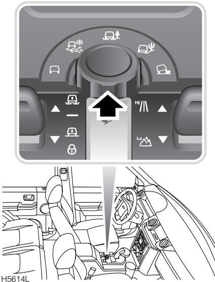
Ceux-ci permettent au conducteur de spécifier au véhicule le type de terrain sur lequel il doit se déplacer. Suivant le programme spécial sélectionné, le système optimise les réglages du véhicule pour les conditions du moment, en offrant au véhicule une traction, une tenue de route et un "comportement" optimum.
