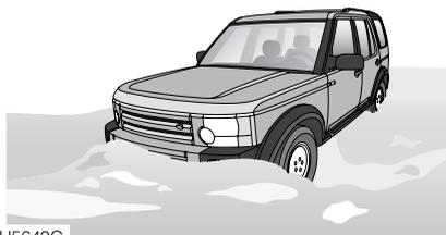
**Mise en garde:** La profondeur maximum recommandée pour les passages à gué est normalement de 600 mm (24 pouces) mais peut atteindre 700 mm (27 pouces) (si le véhicule est équipé d'une suspension pneumatique et se trouve à la hauteur tout-terrain). Des passages à gué fréquents à des profondeurs supérieures au maximum recommandé sont déconseillés.
