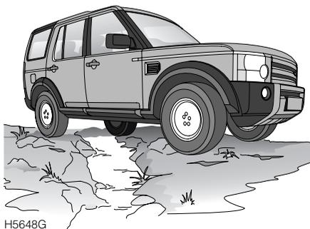
Franchir les fossés à un angle tel qu'au moins trois roues puissent rester en contact avec le sol. Si on tente de franchir un fossé perpendiculairement, les deux roues avant tomberont ensemble dans le fossé et le châssis ainsi que le pare-chocs avant pourraient se coincer des deux côtés du fossé. Si l'état du terrain est tel qu'il n'y a pas d'autre solution, la sélection de la hauteur "tout-terrain" de la suspension pneumatique\* pour augmenter la garde au sol peut être utile.
