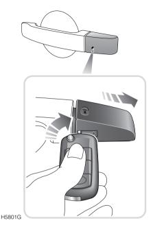
En cas de défaillance de l'émetteur, la serrure de la porte avant gauche comporte une fonction d'accès d'urgence. La clef se trouvant dans la fente sous le capuchon de la poignée, il est possible de tirer légèrement le capuchon vers l'extérieur et de le déplacer ensuite en arrière pour le décrocher. La clef peut alors être utilisée pour déverrouiller le véhicule. Pour une description complète de cette fonction, voir Verrouillage / déverrouillage de secours, 44
