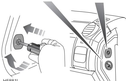
Du côté passager, ouvrir la porte avant et insérer la clef de contact dans l'interrupteur de neutralisation d'airbag. La faire tourner en position de coupure "OFF".
