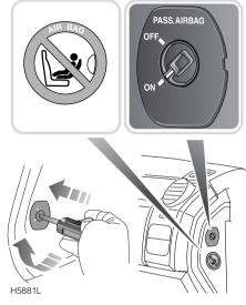
Du côté passager, ouvrir la porte avant et insérer la clef de contact dans l'interrupteur de neutralisation d'airbag. La faire tourner en position de coupure "OFF".
