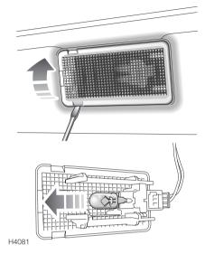
Insérer la lame plate d'un petit tournevis sous le verre et l'extraire prudemment de la lampe. Tirer l'ampoule pour l'enlever.
