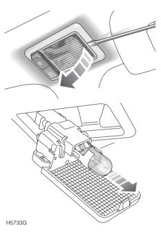
Insérer la lame plate d'un petit tournevis dans le cran sur le côté du verre et extraire prudemment ce dernier de la lampe. Tirer l'ampoule pour l'enlever.
