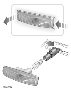
Pousser fermement le verre vers l'avant du véhicule et dégager le feu de l'aile. Faire tourner le porte-ampoule pour le dégager du feu et dégager l'ampoule du porte-ampoule.
