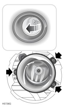
Pour atteindre l'ampoule : à l'aide d'un outil approprié, dégager le panneau d'encadrement du phare antibrouillard du pare-chocs avant. Enlever les trois vis de maintien pour dégager l'ensemble du pare-chocs avant.
