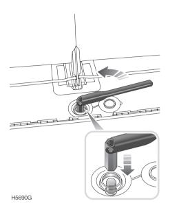
3. Placer la clef d'écrou de roue sur l'écrou du treuil de levage de la roue et la faire tourner dans le sens inverse des aiguilles d'une montre pour abaisser la roue de secours.
