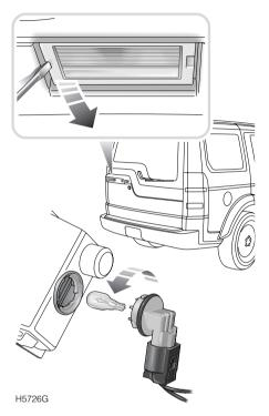
Le hayon supérieur étant ouvert, utiliser un levier approprié pour dégager le verre du feu du hayon (voir médaillon). Faire tourner le porte-ampoule dans le sens inverse des aiguilles d'une montre pour l'enlever puis tirer l'ampoule du porte-ampoule.
