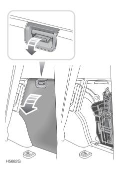
Sur les véhicules à sept places, la trousse d'outils de changement de roue se trouve derrière un couvercle d'accès dans l'espace de chargement arrière.
