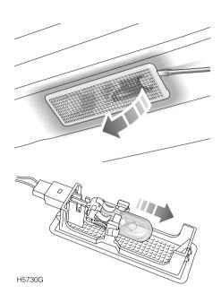
La porte du côté approprié étant ouverte, insérer la lame plate d'un petit tournevis sous le bord avant du verre pour extraire la lampe de la porte. Tirer l'ampoule pour l'enlever.
