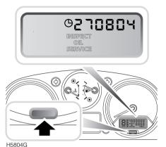
Pour afficher la date de la révision suivante, placer la clef de contact en position 1 et appuyer ensuite sur le bouton de contrôle du système (fléché) en moins de 5 secondes. La date de la révision suivante (jj.mm.aa) est affichée pendant 5 secondes.
