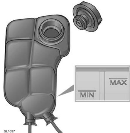
Sicherstellen, dass der Kühlmittelstand zwischen den beiden Kühlmittelstandsmarkierungen an der Seite des Ausgleichsbehälters bleibt.
