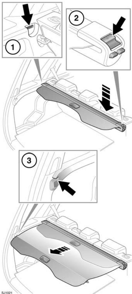
1. Den Führungszapfen auf der linken Seite der Kofferraumabdeckung in den Schlitz einführen.
