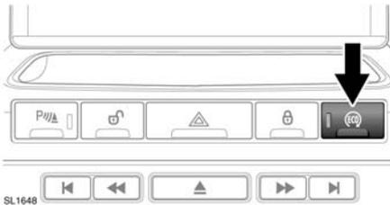
Um das System auszuschalten (automatisches Abstellen/Wiederanlassen des Motors verhindern), die Taste **ECO** drücken. Die LED erlischt und bestätigt damit, dass das System ausgeschaltet ist.
