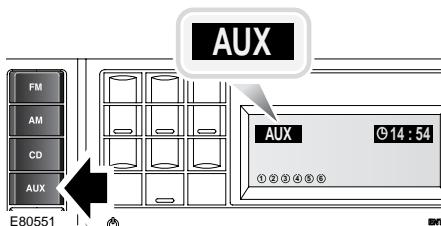
Para escuchar una fuente auxiliar, conecte el aparato y pulse momentáneamente el botón **AUX**. La unidad reproducirá audio a través del enchufe para clavija estéreo de 3,5 mm.
