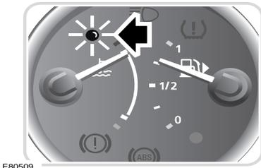
Si la aguja sube del punto medio, el refrigerante del motor se está calentando demasiado. Si la aguja pasa al sector rojo y se ilumina la luz de aviso ROJA (señalada por una flecha), el motor podría resultar gravemente dañado (en estas circunstancias, puede apagarse el aire acondicionado y reducirse el rendimiento del motor para minimizar la carga del motor).
