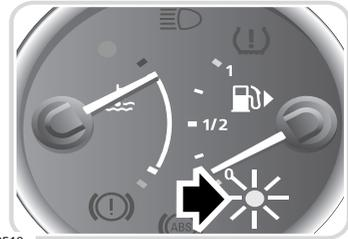
Cuando en el depósito sólo queden 12 litros de combustible, se enciende la luz de aviso amarilla de bajo nivel de combustible (señalada por una flecha).
