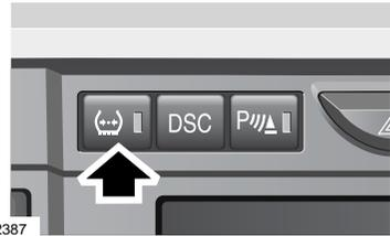
1. Appuyez au moins quatre secondes sur le bouton du système TPM. Le commutateur de démarrage doit être en position II et le moteur ne doit pas tourner.
