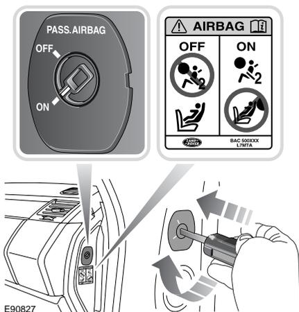
Avant d'installer un dispositif de retenue pour enfant sur le siège avant, ouvrez la porte passager et, à l'aide de la clé de contact, tournez le commutateur d'airbags en position **OFF**.
