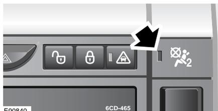
Lorsque le commutateur d'airbag est en position **OFF**, le témoin d'état de l'airbag passager (indiqué par une flèche) s'allumera quand la clé de contact est mise en position **II**.
