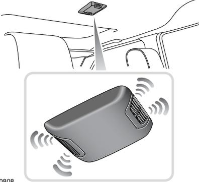
Quatre capteurs montés dans le toit surveillent l'espace intérieur et déclenchent l'alarme si un déplacement d'air est détecté dans l'habitacle.
