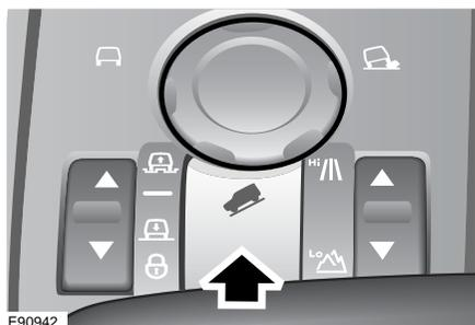
Appuyez brièvement sur le bouton (indiqué par une flèche) pour activer le contrôle d'adhérence en descente (HDC).
