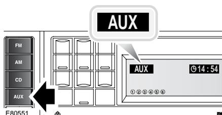
Pour écouter une source auxiliaire, connectez l'appareil et appuyez brièvement sur le bouton **AUX**. La lecture audio de l'équipement s'effectue via la prise jack stéréo 3,5 mm.
