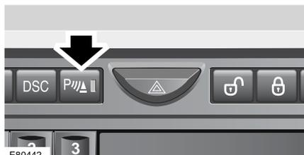
Dans un espace limité, l'aide au stationnement avant peut être activée manuellement en appuyant sur le commutateur de la planche de bord. Ce commutateur s'allume et une brève tonalité est émise pour confirmer l'activation.
