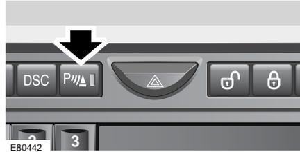
Si vous conduisez dans un espace réduit, vous pouvez activer manuellement l'aide au stationnement avant en appuyant sur le commutateur de la console centrale (indiqué par une flèche).
