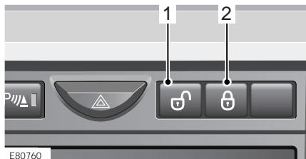
1. Bei Betätigung des Entriegelungsschalters werden alle Türen entriegelt.
