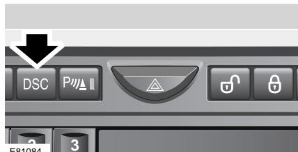
Zum Ausschalten der DSC den DSC-Schalter im Cockpit kurz gedrückt halten (die DSC-Warnleuchte leuchtet ununterbrochen). Die Außerbetriebnahme der DSC hat keinen Effekt auf die Traktionskontrolle.
