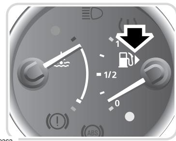
Die Tankklappe befindet sich hinter dem hinteren rechten Radlauf. Ein Pfeil in der Kraftstoffvorratsanzeige verweist auf die betreffende Fahrzeugseite.
