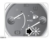
Die gelbe Warnleuchte in der Kraftstoffvorratsanzeige leuchtet auf, wenn der nutzbare Tankinhalt auf 12 Liter abgesunken ist. Mit dem Restvorrat müsste das Fahrzeug eine Reichweite von etwa 80 km haben.
