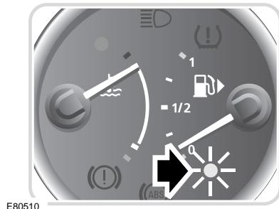
Die gelbe Warnleuchte in der Kraftstoffvorratsanzeige leuchtet auf, wenn der nutzbare Tankinhalt auf 12 Liter abgesunken ist. Mit dem Restvorrat müsste das Fahrzeug eine Reichweite von etwa 80 km haben.
