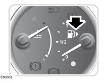
Die Tankklappe befindet sich hinter dem hinteren rechten Radlauf. Ein Pfeil in der Kraftstoffvorratsanzeige verweist auf die betreffende Fahrzeugseite.
