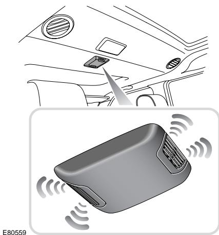
Vier unter dem Dach angeordnete Sensoren überwachen den Innenraum und lösen den Alarm aus, wenn dort eine Luftbewegung registriert wird.
