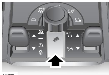
Die HDC sollte in Verbindung mit einem sinnvollen Gang benutzt werden.
