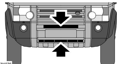
Sauberes Wasser mit einem Schlauch durch den Frontstoßfänger spritzen (siehe Pfeil), um Kühler und Klimakondensator von Schlammablagerungen zu befreien.
