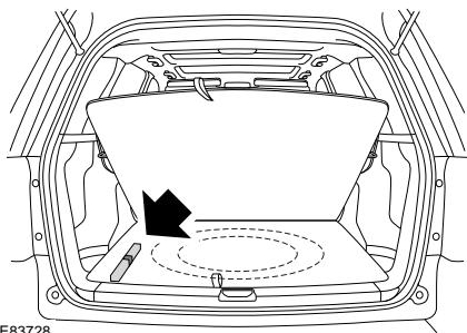
L'emplacement prévu pour le triangle de signalisation se trouve sous le plancher de l'espace de chargement, à gauche.
