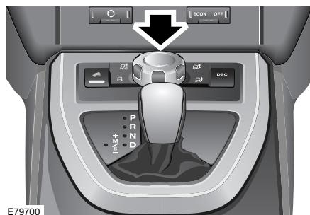
Un bouton rotatif à l'avant du sélecteur de vitesses permet de sélectionner le programme spécial requis. Lorsque le sélecteur atteint l'une ou l'autre extrémité de la plage de sélection, il peut être tourné plus loin, mais sans aucun effet.
