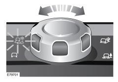
Après avoir appuyé sur le bouton de démarrage/arrêt du moteur, les témoins situés autour du bouton rotatif s'allument. Le programme actif est mis en surbrillance en jaune et l'icône du programme apparaît sur l'afficheur de messages.
