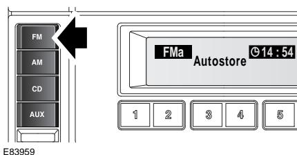
Pour enregistrer automatiquement les stations sur les systèmes audio standard, sélectionnez la bande requise et appuyez pendant 3 secondes sur le bouton de bande correspondant. **Autostore** (enregistrement automatique) s'affiche à l'écran et les stations sont enregistrées sous les numéros prédéfinis par ordre d'apparition.
