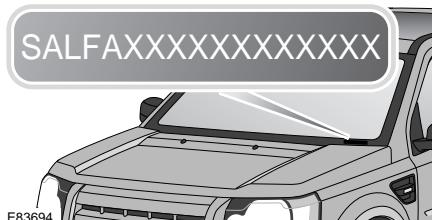
Pour décourager les voleurs potentiels et aider la police, le VIN est gravé sur une plaque visible à travers le pare-brise, en bas à gauche.
