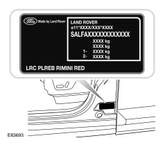
Le numéro d'identification du véhicule (VIN) et les charges maximales recommandées pour le véhicule sont gravés sur une plaque rivetée en bas du côté serrure de la porte avant gauche (porte avant droite en Chine). Le VIN gravé doit correspondre au VIN inscrit dans le livret de service et au VIN visible à travers le pare-brise avant.
