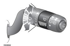
Le laps de temps entre chaque balayage peut être ajusté selon les conditions climatiques. Tournez la bague rotative vers le haut pour augmenter le laps de temps entre chaque balayage et vers le bas pour le réduire.
