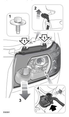
Pour changer l'ampoule d'un phare, vous devez d'abord retirer le bloc optique.
