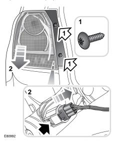
Pour changer l'ampoule d'un bloc optique arrière, vous devez d'abord retirer celui-ci.
