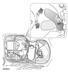
Un levier vous permet d'ajuster le faisceau dans la position correcte selon le pays où vous conduisez, que les véhicules roulent à gauche ou à droite.
