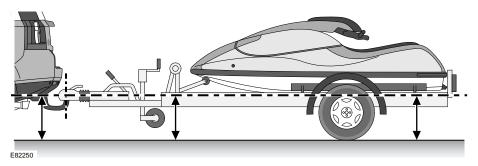
Pour conserver la stabilité du véhicule, il faut absolument charger la remorque de sorte qu'elle reste parallèle au sol. Ceci est particulièrement important pour le tractage des remorques à double essieu.
